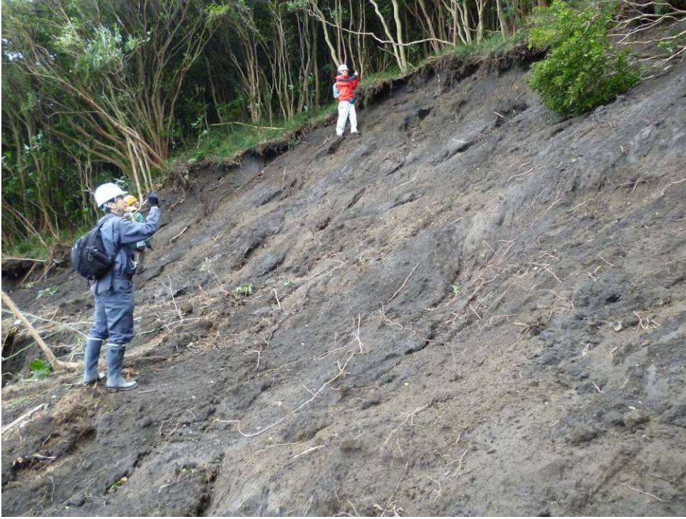
写真1：御神火スカイラインより上方のスコリア丘内部が崩壊したと考えられる斜面。
