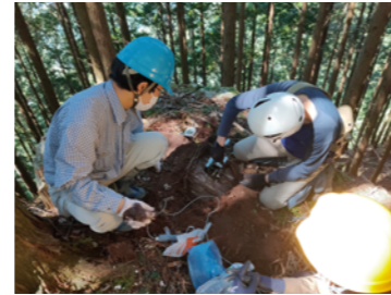
斜面への地震計の設置の様子 Installation of seismometers on the slope
