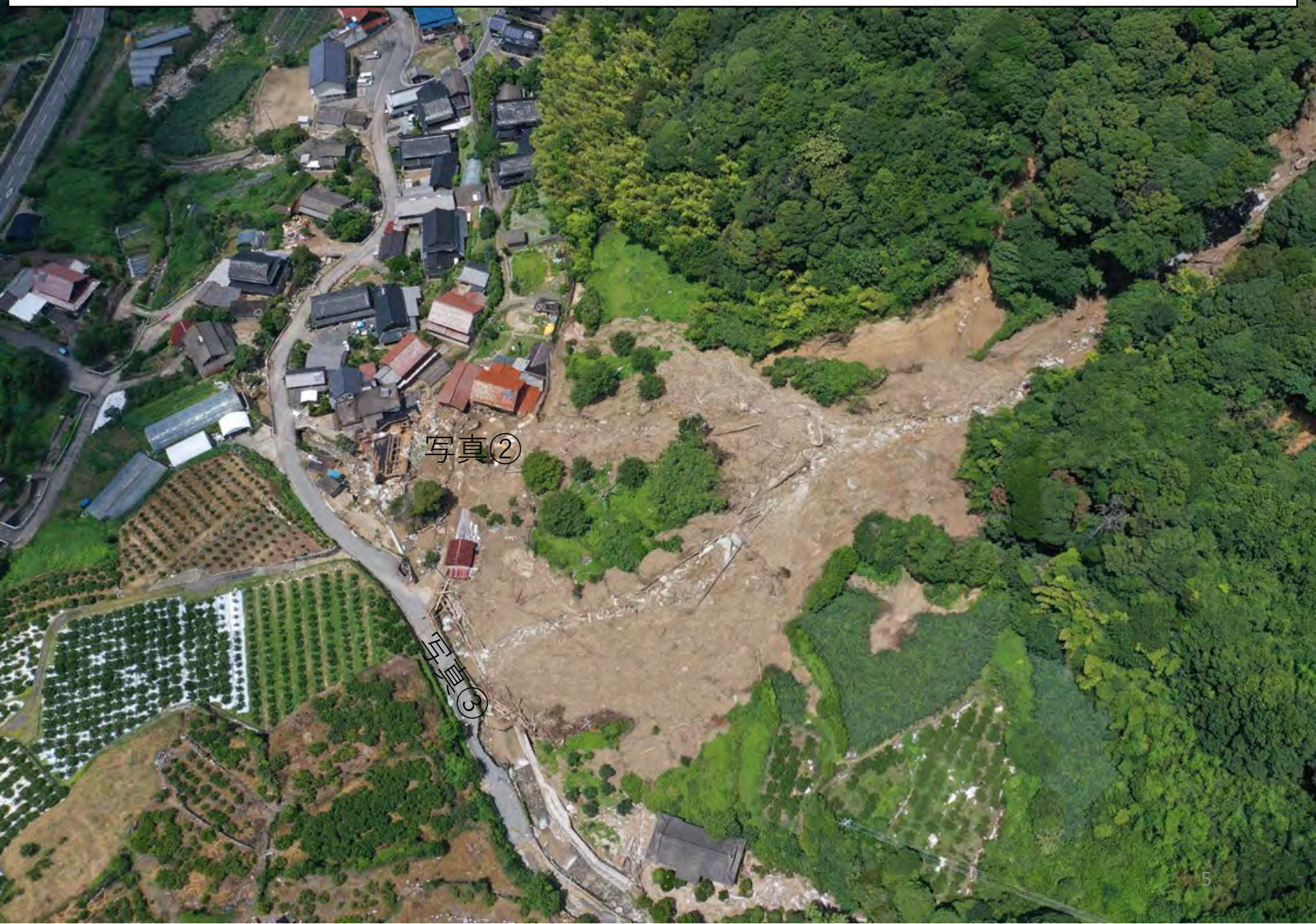
①土石流発生場所末端部付近のドローンからの空撮。土石流は扇状に広がり拡大した。
