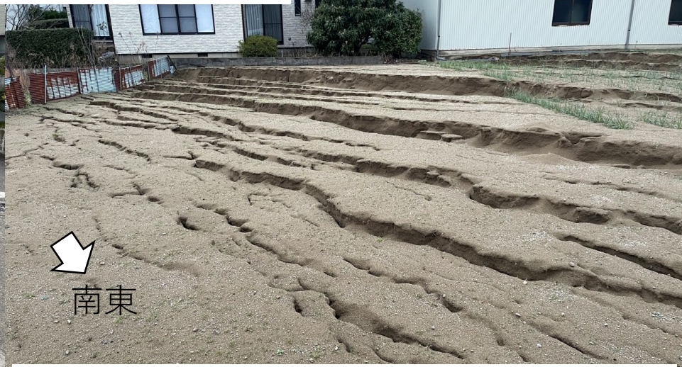
⑥：グラウンド北側の陥没帯．複数の正断層が形成され，一部は半地溝状となって，傾動地塊の頂部が北へ傾斜する．
