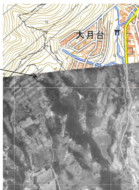
図2 1945-1950年の状況（地理院地図）。崩壊箇所が古い造成地であることがわかる。
