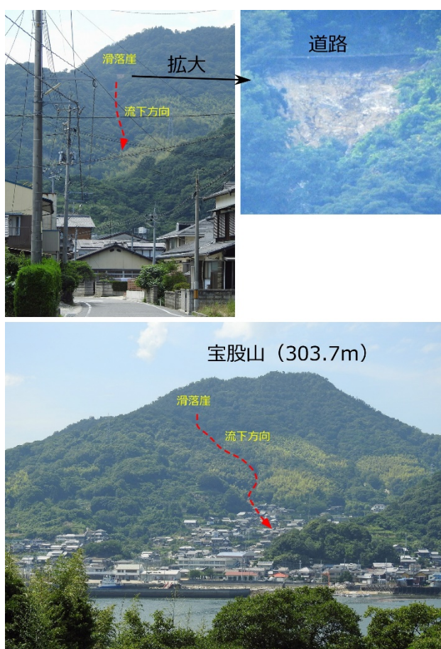
第3図 有津の崩壊源と下方の崖錐
