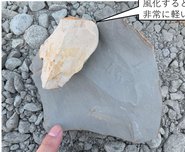
比較的新鮮な珪質シルト岩（灰色）と風化した珪質シルト岩（白色）
